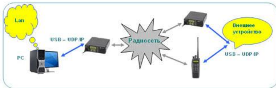
Рисунок 3. Пакетная передача данных в MOTOTRBO
